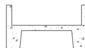
1° ETAPA CABEZAL PREFABRICADO ESCALA 1:50
