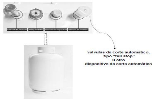
Figura 2, Esquema de tanque vertical (garrafón).
