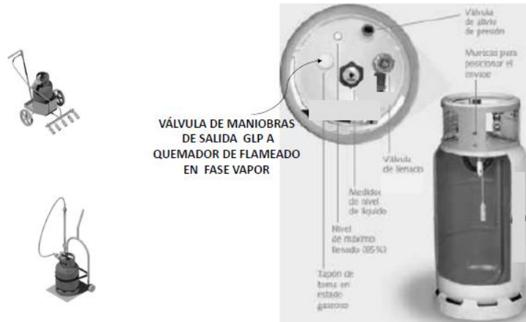
Figura 3. Esquema cilindros removibles, recargables en micro planta.
