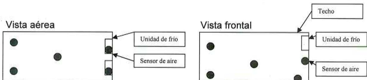
5.5.4.4. En cámaras con las unidades de frío en la parte media, los sensores se colocarán de la siguiente manera:
