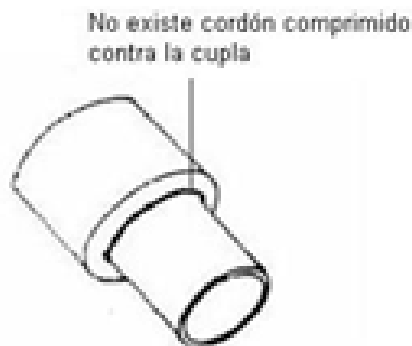
Figura 9 - Cordón deficiente, el material fue arrastrado por la herramienta calefactora hacia el interior de la cupla.
