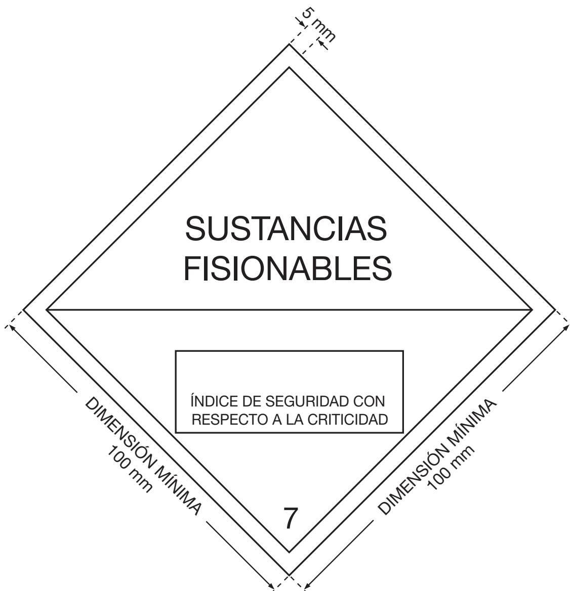
Fig. 5. Etiqueta para el ISC. La anchura mínima de la línea dentro del borde que forma el rombo será de 2 mm. El color de fondo de la etiqueta será blanco y los caracteres y líneas impresos serán negros.
