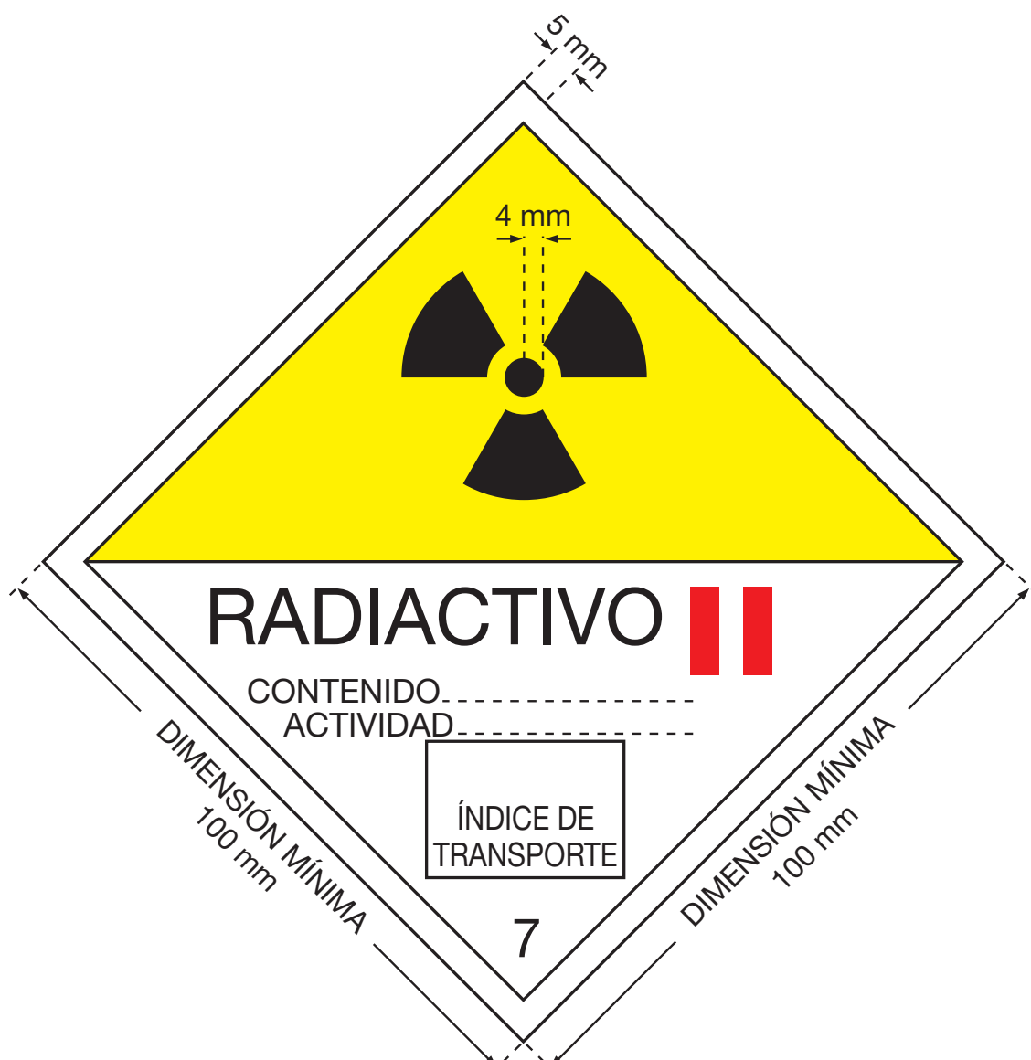
Fig. 3. Etiqueta para la categoría II-AMARILLA. La anchura mínima de la línea dentro del borde que forma el rombo será de 2 mm. El color de fondo de la mitad superior de la etiqueta será amarillo y el de la mitad inferior, blanco, el trébol y los caracteres y líneas impresos serán negros y las barras que indican la categoría serán rojas.
