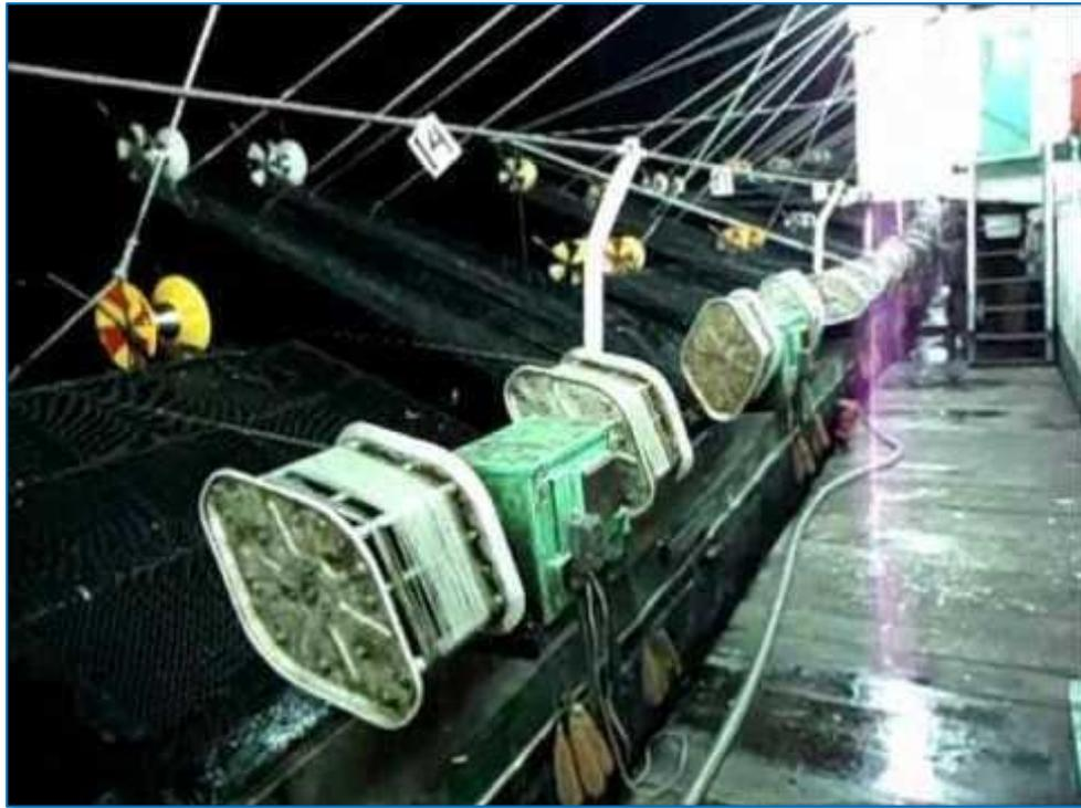
**Figura 10 e:** Foto de la posición en borda de las máquinas calamareras automáticas
