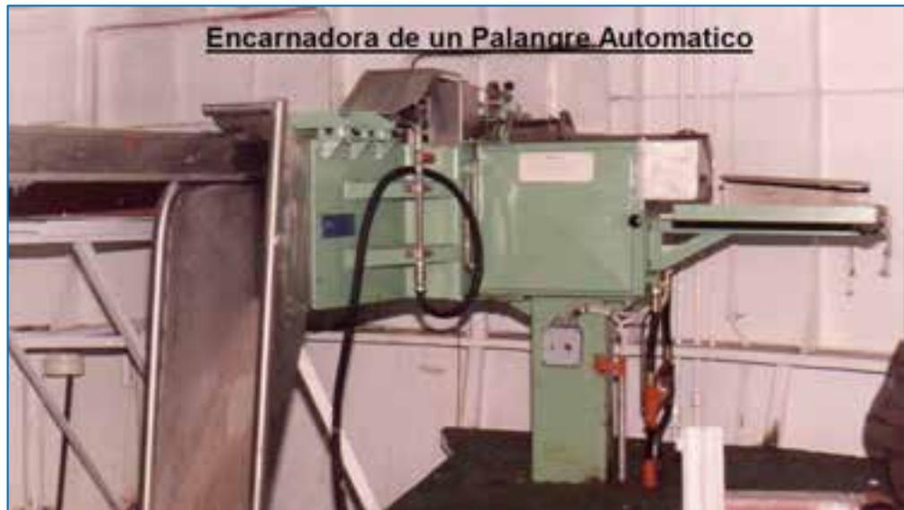
**Figura 9 c:** Foto de una encarnadora de un palangre Automático
