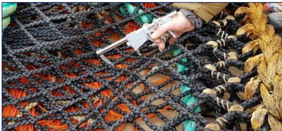
**Figura 2:** Medición con calibres de tensión tipo CIEM
