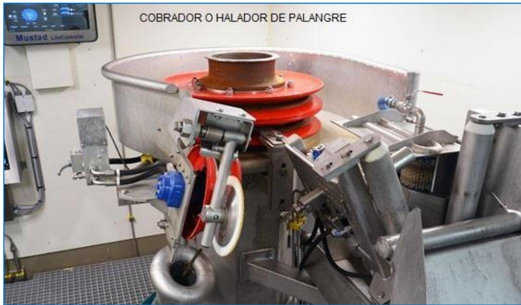
**Figura 9 d:** Foto de Halador de palangre Automático
