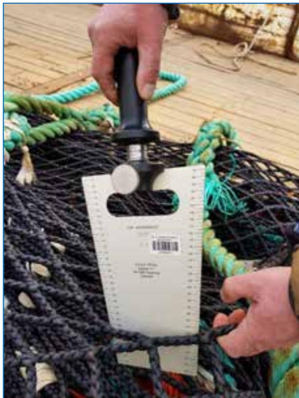
**Figura 1:** Medición con dinamómetros y galgas UTZON
