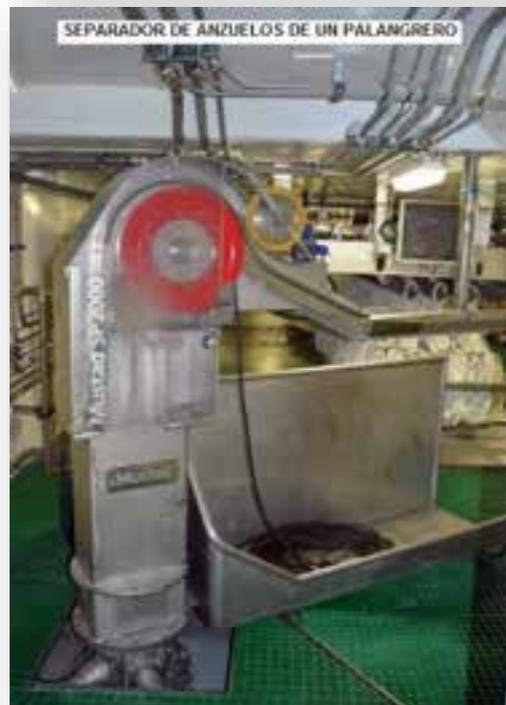
**Figura 9 d:** Foto de Separador de anzuelos de un palangre Automático
