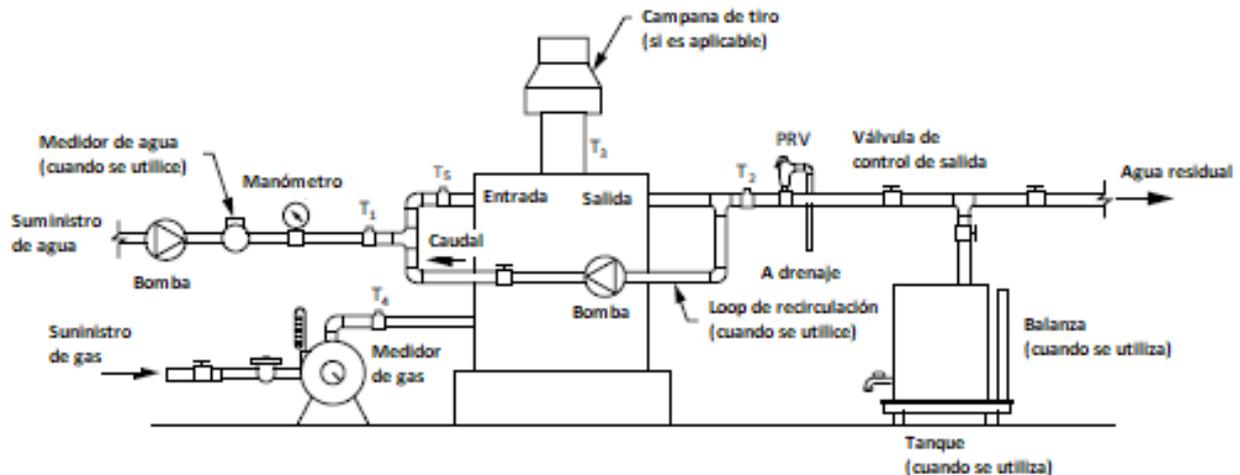
T<sub>1</sub> = Ubicación para la medición de temperatura en la línea de suministro de agua
